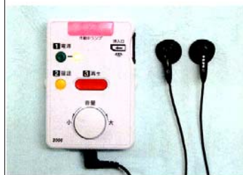
ICプレーヤーには3つのボタンと2つのランプ、音量調節つまみが付いています。2つのランプ(赤、黄緑)はICプレーヤー
