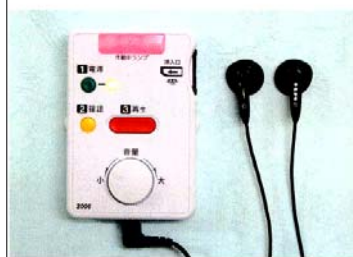
ICプレーヤーには3つのボタンと2つのランプ、音量調節つまみが付いています。2つのランプ(赤、黄緑)はICプレーヤー
