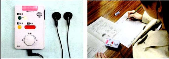
ICプレーヤーには3つのボタンと2つのランプ、音量調節つまみが付いています。2つのランプ(赤、黄緑)はICプレーヤー 受験者には問題冊子、解答用紙とともに、ICプレーヤー、イヤホン及び音声メモリーが配られます。
